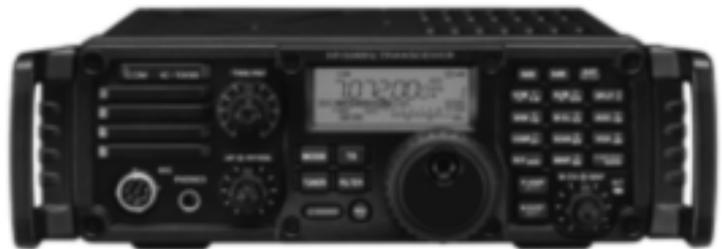
L'ICOM IC-7200 est un émetteur-récepteur solidement construit pour fonctionnement sur les bandes HF/ 6 mètres. La puissance est de 100 watts. Les particularités incluent des commandes faciles à utiliser, DSP le filtrage avec 51 passband de largeur
