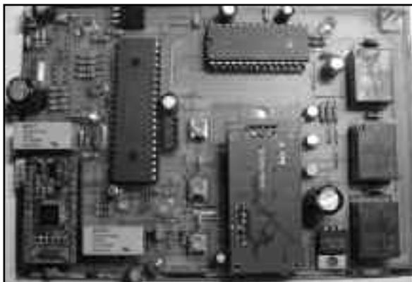
pourra surveiller la qualité des signaux GPS, et effectuer un reset de celui-ci s'il tombe en panne. Si le signal ne peut pas être récupéré, il procédera au largage de la charge. Il surveille aussi l'altitude du ballon, et sa position, pour activer en temps opportun, des relais pour larguer le
