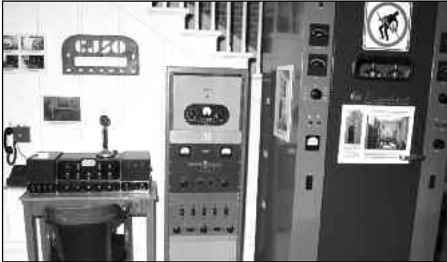
**Console de studio, appareils de contrôle, émetteur AM 1 kW de la Cie RCA**
