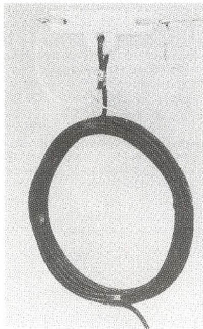
Fig. 3 - Un balun étrangleur à noyau d'air est assez léger pour qu'on puisse le suspendre au point d'alimentation d'une antenne solidement installée.
