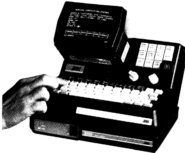
FIGURE 1 — Ce terminal mobile fabriqué par la compagnie MDI de Vancouver est muni d'un système de correction aval des erreurs (courtoisie de National Mobile Radio Communications Inc).
