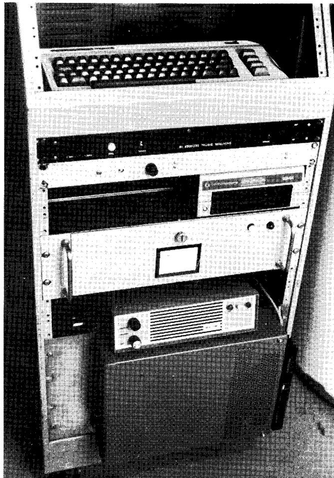
Le système SIGMA: L'ordinateur est situé en haut. Au centre, on distingue l'unité de disques et la cage des modems. En bas, le bloc d'alimentation surmonté du panneau de contrôle du transmetteur.
